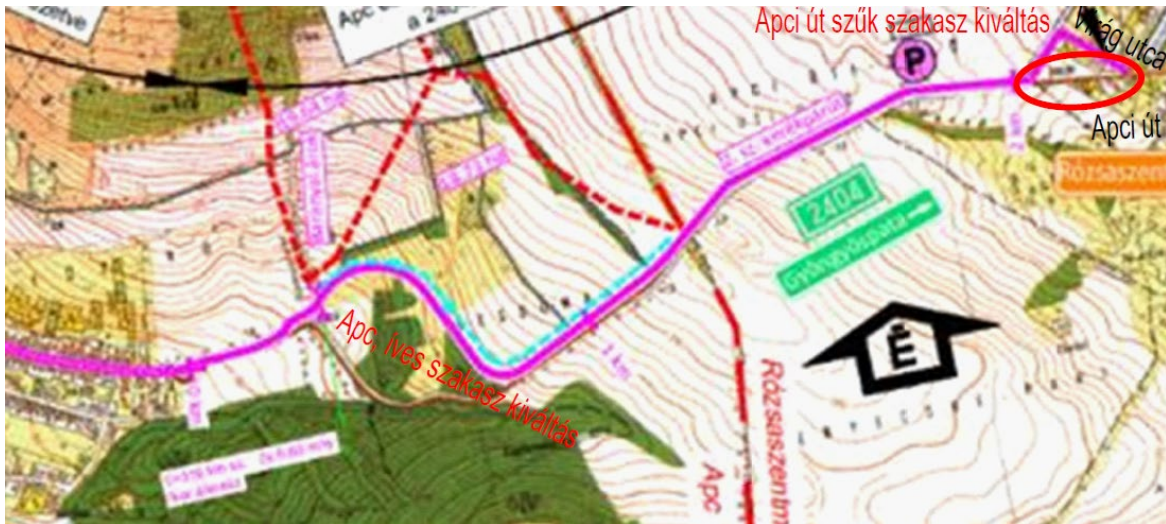
átnézeti helyszínrajz részlete – Engedélyezési terv (RODEN Mémöki Iroda Kft. – Apc-Rózsaszentmárton (EV14) között kerékpárút tervezése 4,180 km hosszban)
